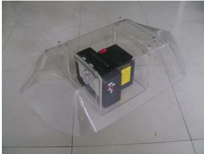
รูปที่ 5.2 การติดตั้งอุปกรณ์ Sensor Node และแบตเตอรี่เข้าไปในอุปกรณ์ป้องกันน้ำ
