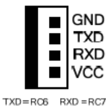
รูปที่ 3.18 การจัดเรียงขั้วต่อพอร์ต RS232 ของบอร์ดควบคุม
