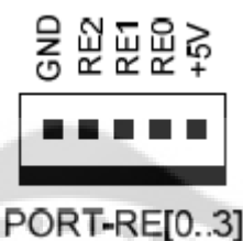
รูปที่ 3.19 การจัดเรียงขั้วต่อ PORT-RE ของบอร์ดควบคุม
