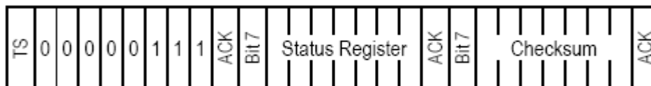
รูปที่ 3.10 รูปแบบการอ่านข้อมูลไปยังรีจิสเตอร์ STATUS ของ SHT15
