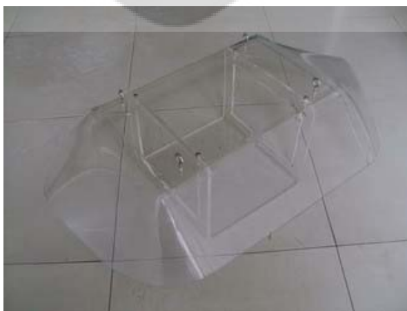
รูปที่ 5.1 อุปกรณ์ป้องกันน้ำสำหรับ Sensor Node
