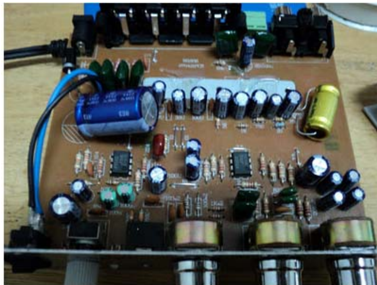
รูป 3 อุปกรณ์จริงที่ประกอบลงบนแผ่นปริ้นต์วงจร ซึ่งเมื่อสร้างเป็นเครื่องขยายกำลังที่บรรจุในกล่องเรียบร้อยแล้ว มีลักษณะดังรูป 4
