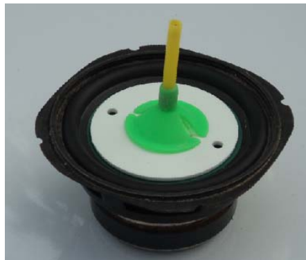
รูป 18 ลำโพงที่ติดตั้งแกนการสั่นซึ่งทำหน้าที่เป็นเครื่องสั่น
