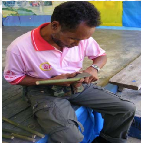
ภาพประกอบ 42 ขั้นตอนที่ 2 การบากไม้ไผ่เพื่อทำซีลีโอย
