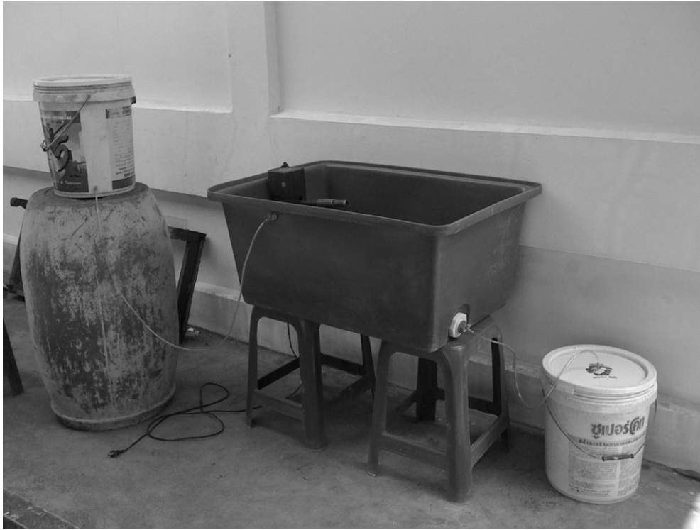
ภาพประกอบ 11 แสดงระบบบำบัดน้ำเสียแบบใช้ออกซิเจน ชนิดใช้เครื่องเติมอากาศ
