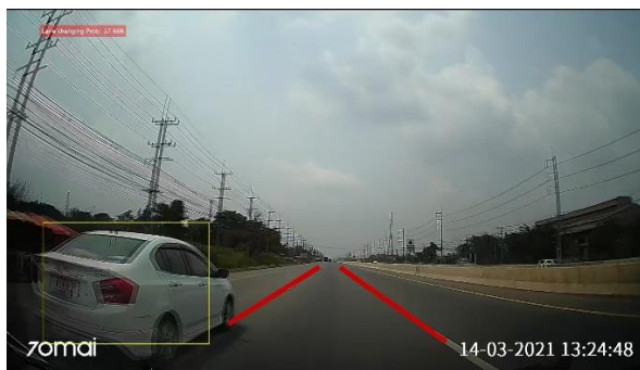
รูปที่ 3.12 ตัวอย่างรูปภาพผลลัพธ์การตรวจจับความเป็นไปได้ที่รถด้านหน้าจะขับเข้ามาในเลนของรถที่ทำการทดลอง
