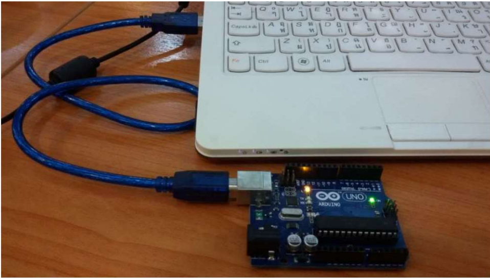
รูปที่ 1.12 ต่อบอร์ด Arduino เข้ากับคอมพิวเตอร์ผ่านทางพอร์ต USB
