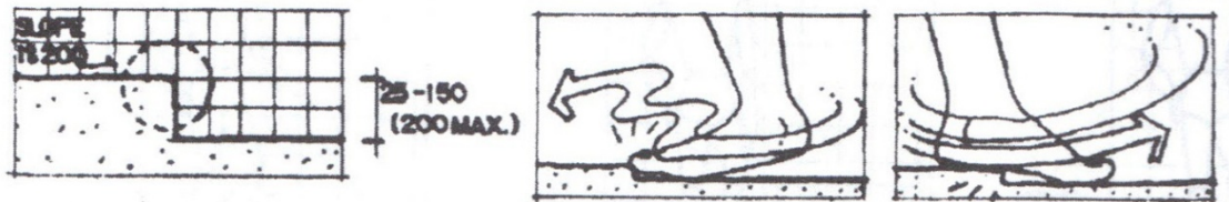
ภาพประกอบ 35 พื้นลดระดับภายในห้องน้ำ
