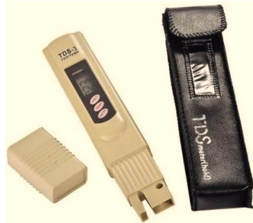
ภาพที่ 7 เครื่อง TDS Meter
