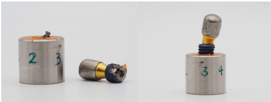
ภาพที่ 8 ตัวอย่างรูปแบบความล้มเหลว Ff กลุ่ม WD บริเวณ T5/6 ไปยัง T2/3 (ซ้าย) และ T5/6 ไปยัง T1 (ขวา)
