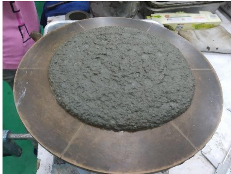
ภาพที่ 1 การวัดค่าการไหลแผ่ของมอร์ตาร์
