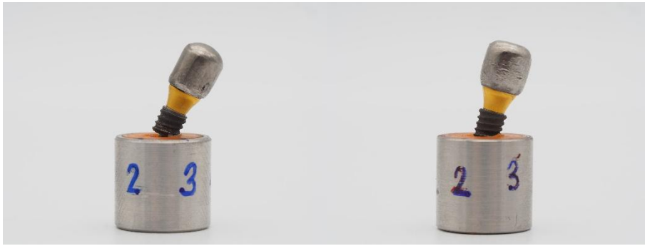
ภาพที่ 6 ตัวอย่างรูปแบบความล้มเหลว Ff กลุ่ม ND บริเวณ T5/T6
