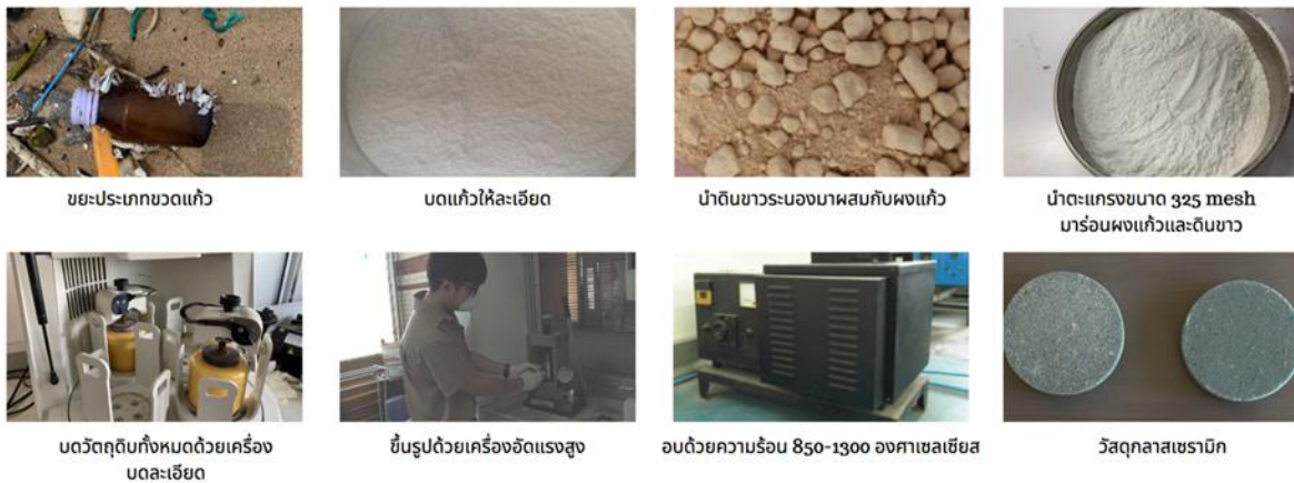
ภาพที่ 2 กระบวนการเตรียมและผลิตกลาสเซรามิกแบบเผาผนัง
