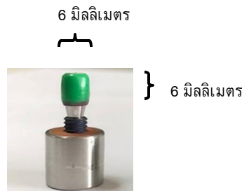
ภาพที่ 1 แสดงการแต่งซี่ฟันบนหลักยึดเป็นรูปครึ่งทรงกลมกว่าขนาดสูง 6 มิลลิเมตร เส้นผ่านศูนย์กลาง 6 มิลลิเมตร
