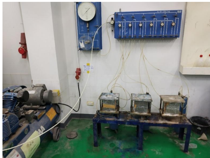
ภาพที่ 3 ชุดอุปกรณ์ทดสอบการซึมผ่านน้ำในตัวอย่างมอร์ตาร์
