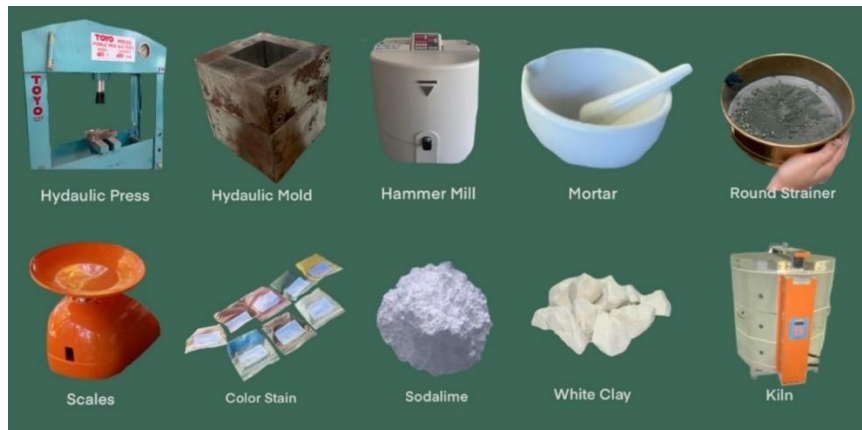
ภาพที่ 1 วัสดุและอุปกรณ์สำหรับผลิตกลาสเซรามิก
