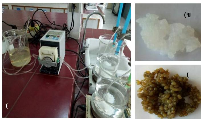
ภาพที่ 2 การจัดอุปกรณ์สำหรับเตรียมเม็ดโคโตซาน (ก) เม็ดโคโตซานที่เตรียมได้ (ข) เม็ดโคโตซานที่ผ่านการใช้งานสำหรับการกำจัดสีของสารสกัดหญ้าหวาน (ค)
