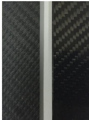
ภาพที่ 7 ชั้นทดสอบจากการผลิตด้วยกระบวนการวัลคัมอินฟิวชัน (ด้านซ้าย) ชั้นทดสอบจากการผลิตด้วยกระบวนการวัลคัมแบคกิ้ง (ด้านขวา)
