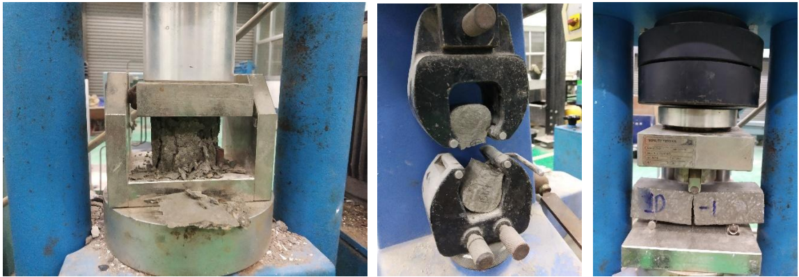
ภาพที่ 2 ชุดอุปกรณ์ทดสอบการรับกำลังของตัวอย่างมอร์ตาร์
