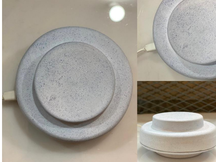
ภาพที่ 5 ที่ชาร์ตสมาร์ทโฟนไร้สายจากวัสดุกลาสเซรามิก
