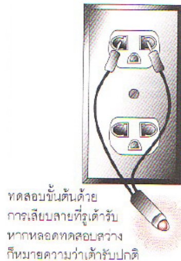
ภาพประกอบ 11 การทดสอบวงจรไฟฟ้าด้วยหลอดทดสอบ
