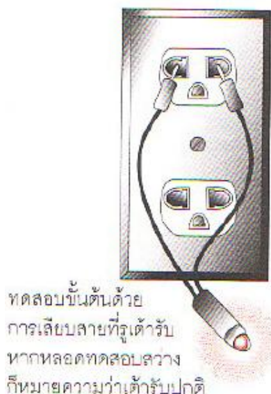
ภาพประกอบ 5 การทดสอบวงจรไฟฟ้าด้วยหลอดทดสอบ
