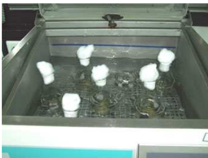
ภาพประกอบ 15 แสดงขั้นตอนการบ่มเชื้อในอ่างน้ำควบคุมอุณหภูมิ
