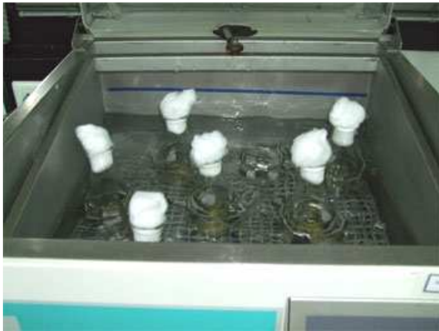
ภาพประกอบ 41 แสดงการบ่มเชื้อในอ่างน้ำควบคุมอุณหภูมิสำหรับการบ่มเชื้อจุลินทรีย์
