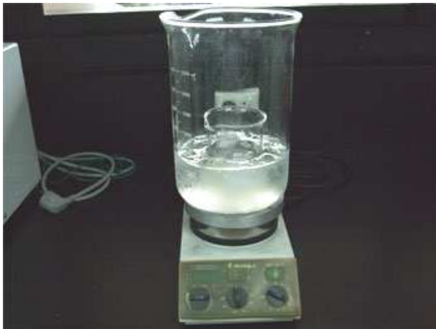
ภาพประกอบ 43 แสดงการทำให้เอนไซม์เข้มข้นโดยวิธี Solvent precipitation
