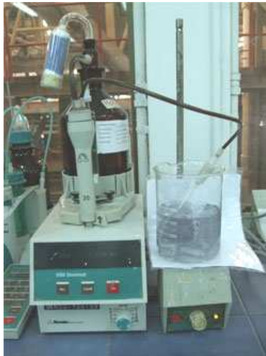
ภาพประกอบ 59 แสดงวิธีการหาโปรตีนของมอลโทเดกซ์ทริน ขั้นตอนการติเตรตกับ H_2SO_4
