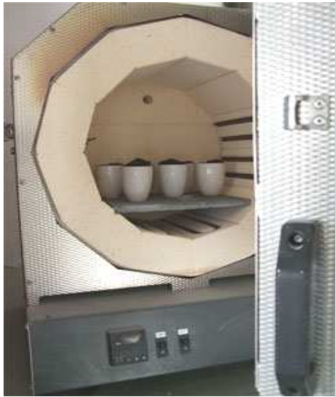
ภาพประกอบ 55 แสดงวิธีการหาถ้ำซัลเฟตของ มอลโทเดกซ์ทริน ขั้นตอนเข้าเตาเผาที่อุณหภูมิ 550 องศาเซลเซียส
