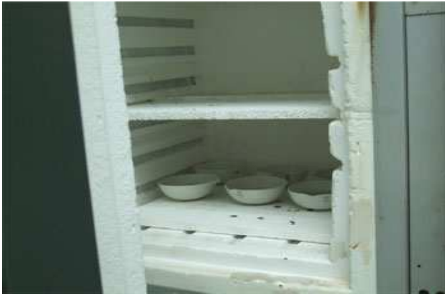
ภาพประกอบ 34 แสดงการนำกระดาษกรองเข้าเตาเผา 550 องศาเซลเซียสเพื่อหาปริมาณสารแขวนลอยระเหย
