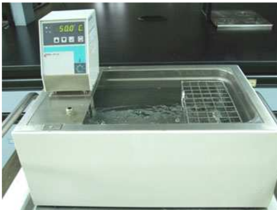
ภาพประกอบ 46 แสดงอ่างน้ำควบคุมอุณหภูมิที่ใช้ในการวิเคราะห์แอกติวิตีของเอนไซม์อะไมเลส
