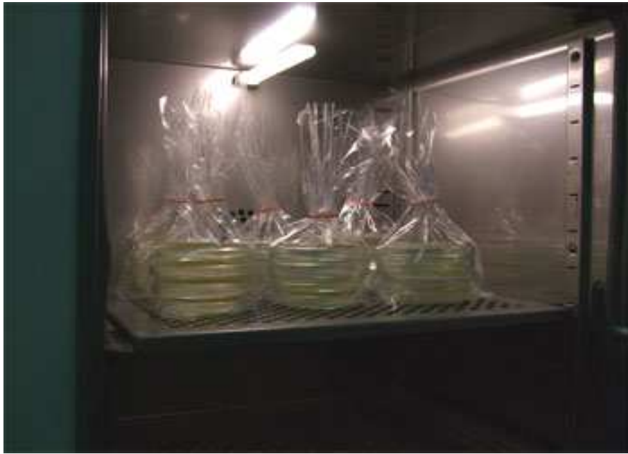
ภาพประกอบ 36 แสดงการบ่มจานเพาะเชื้อในเครื่องบ่มเชื้ออุณหภูมิต่ำเพื่อทำการแยกสายพันธุ์แบคทีเรียที่สามารถผลิตเอนไซม์อะไมเลส
