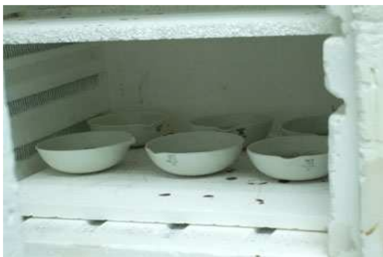
ภาพประกอบ 14 แสดงขั้นตอนการเผากระดาษกรองเพื่อหาปริมาณสารแขวนลอยระเหย
