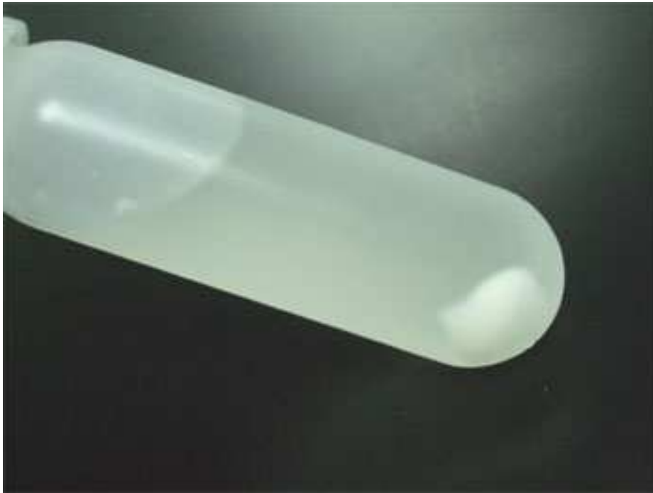
ภาพประกอบ 44 แสดงตะกอนเอนไซม์ที่ได้จากการใช้เครื่องหมุนเหวี่ยงแบบควบคุมอุณหภูมิ
