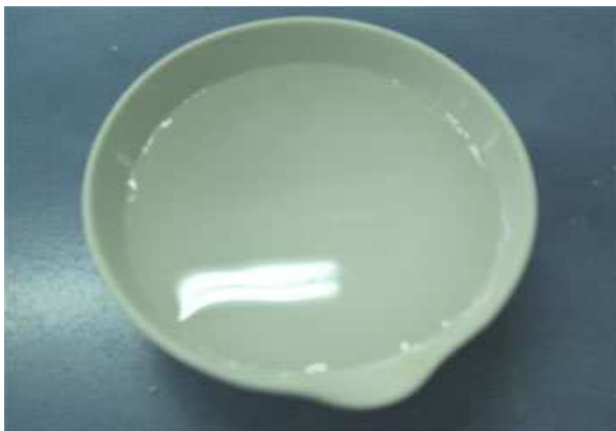
ภาพประกอบ 52 แสดงวิธีการทดสอบการละลายของมอลโทเดกซ์ทรีน ขั้นตอนก่อนนำไประเหยแห้ง
