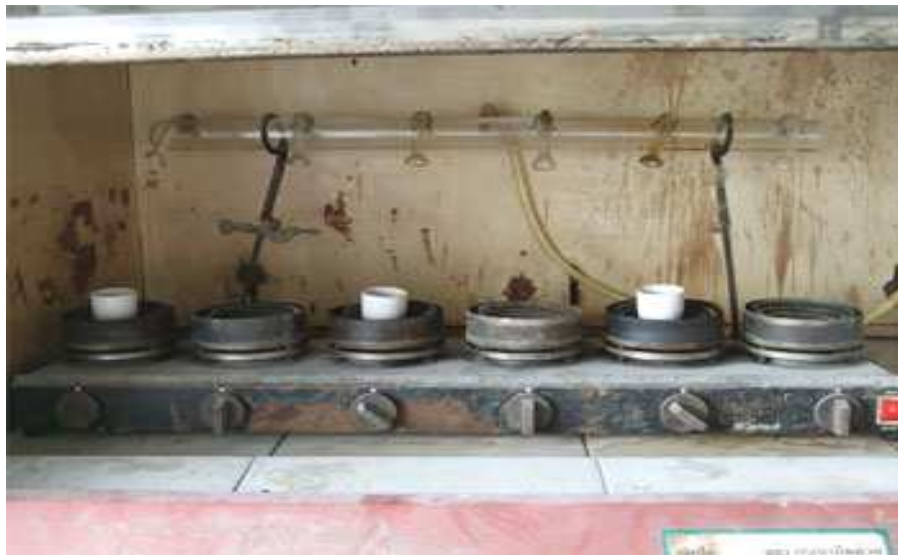
ภาพประกอบ 54 แสดงวิธีการหาเถ้าซัลเฟตของมอลโทเดกซ์ทริน ขั้นตอนให้ความร้อนบน Hot plate จนตัวอย่างกลายเป็นเถ้า
