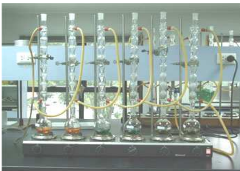
ภาพประกอบ 11 แสดงขั้นตอนการรีฟลักซ์หาปริมาณซีไอดีในน้ำทิ้งและน้ำจากกระบวนการหมัก
