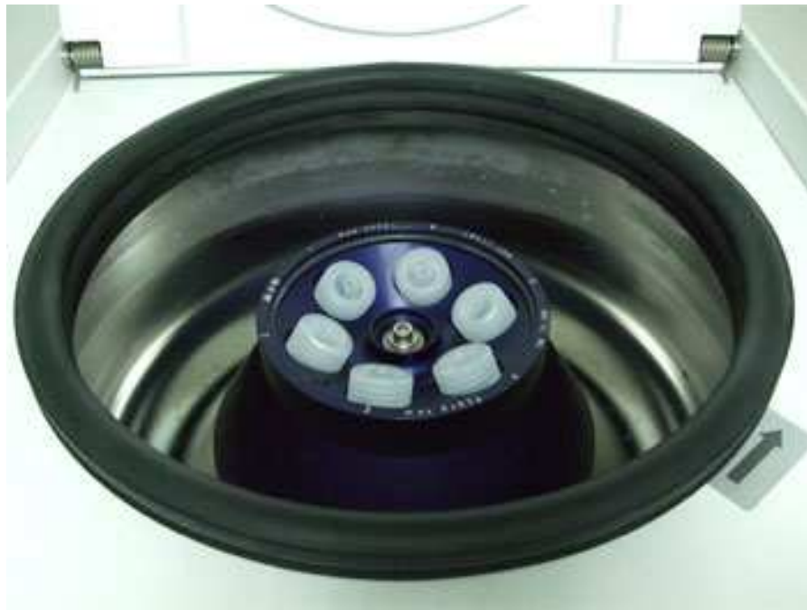
ภาพประกอบ 42 แสดงขั้นตอนการปั่นแยกเซลล์โดยใช้เครื่องหมุนเหวี่ยงแบบควบคุมอุณหภูมิ
