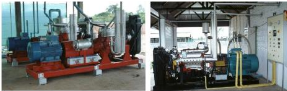
รูปที่ 2.21 เครื่องยนต์ดีเซลตัดแปลง (ใช้ก๊าซชีวภาพ 100%)
