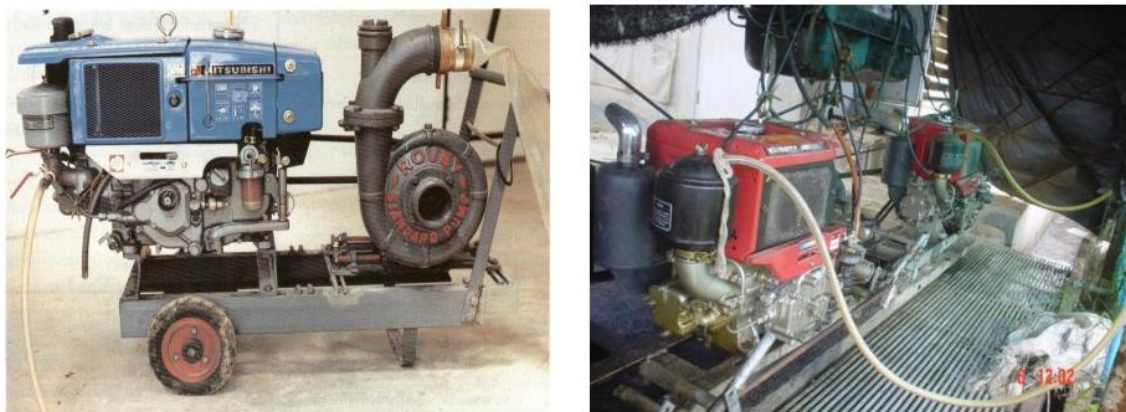
รูปที่ 2.18 เครื่องยนต์ดีเซลขนาดเล็ก (แบบเชื้อเพลิงคู่)
