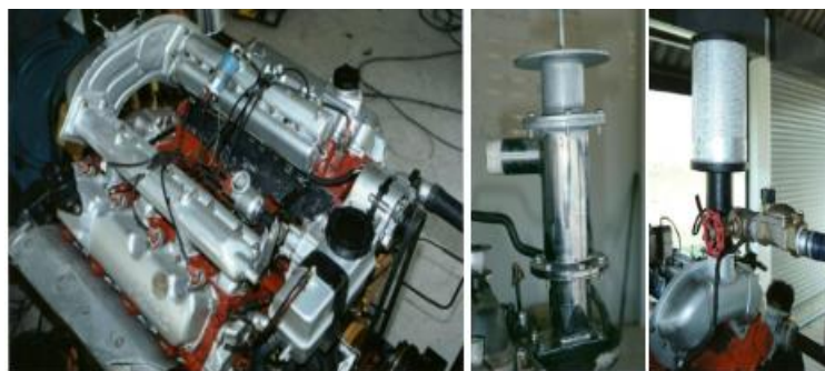
รูปที่ 2.22 ภายในเครื่องยนต์ดีเซลตัดแปลง (ใช้ก๊าซชีวภาพ 100%)
