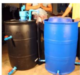
ถังหมัก+ถังเก็บ
