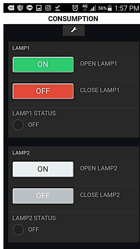
รูปที่ 4.8 หน้าจอควบคุม ปิด เปิดหลอดไฟ โดยผ่านทางฟรีบอร์ดของเน็ตพาย ภายในแอปพลิเคชัน
