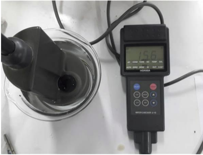
รูปที่ 35 วัดค่า conductivity ของน้ำเกลือ
