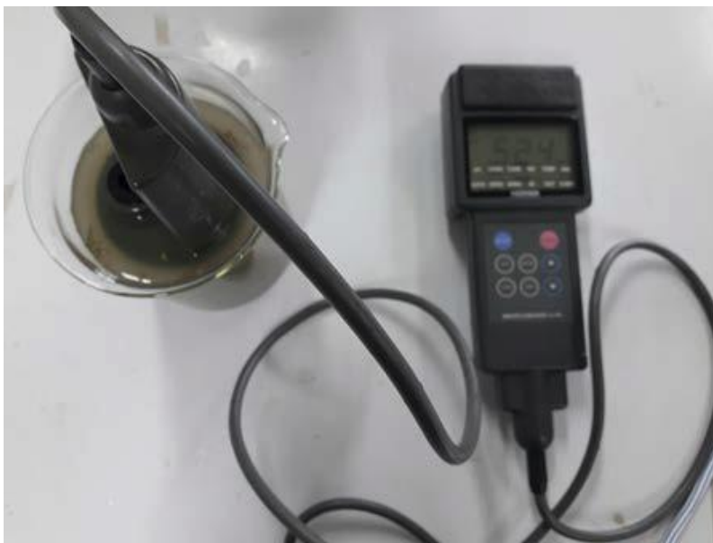
รูปที่ 34 วัดค่า conductivity ของน้ำโคลน
