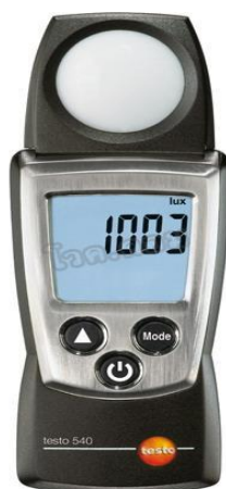
รูปที่ 2.2 เครื่องวัดค่าความส่องสว่าง หรือ “ลักซ์มิเตอร์”
