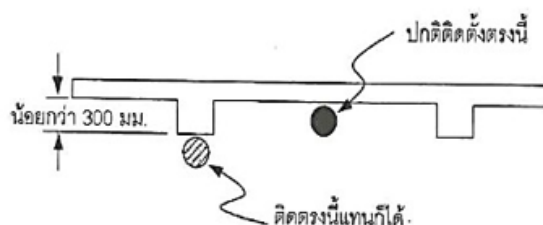
รูปที่ 2.82 การติดตั้งอุปกรณ์ตรวจจับความร้อนใต้คานที่มีความลึกไม่น้อยกว่า 300 มิลลิเมตร
