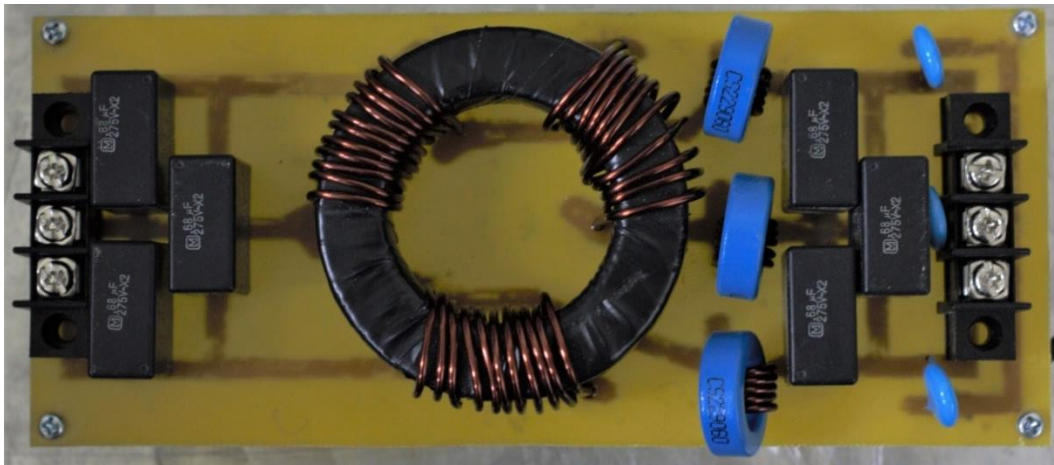
รูปที่ 3.32 วงจรกรองสัญญาณรบกวนแม่เหล็กไฟฟ้าแบบสามเฟสโดยใช้วิธีของ Po-Shen Chen และ Yen-Shin Lai ที่ใช้จริงในการทดลอง
