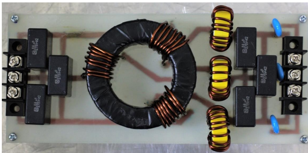
รูปที่ 3.27 วงจรกรองสัญญาณรบกวนแบบแม่เหล็กไฟฟ้าแบบสามเฟสโดยใช้วิธีของ Fu-Yuan Shih, Dan Y. Chen, Yan-Pei Wu และ Yie-Tone Chen ที่ใช้จริงในการทดลอง
