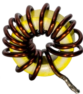
รูปที่ 3.9 ตัวเหนี่ยวนำโหมดผลต่างที่ใช้จริง กรณี L_D = 16.52 \mu\text{H}
