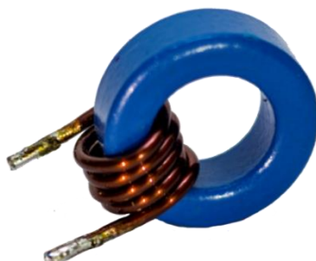
รูปที่ 3.8 ตัวเหนี่ยวนำโหมดผลต่างที่ใช้จริง กรณี L_D = 1.3 \mu\text{H}
