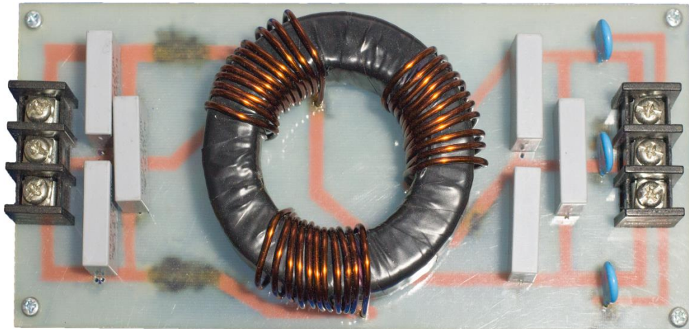
รูปที่ 3.35 วงจรกรองสัญญาณรบกวนแบบแม่เหล็กไฟฟ้าแบบสามเฟสโดยใช้วิธีที่นำเสนอ ที่ใช้จริงในการทดลอง
