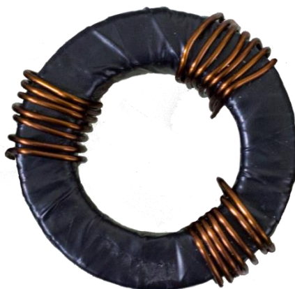
รูปที่ 3.7 ตัวเหนี่ยวนำโหมดผลร่วมที่ใช้จริง กรณี L_C = 0.32 \text{ mH}
