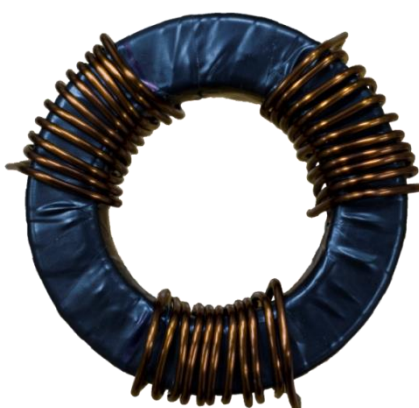
รูปที่ 3.6 ตัวเหนี่ยวนำโหมตผลร่วมที่ใช้จริง กรณี L_C = 0.86 mH
