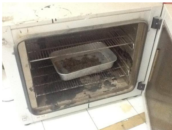
รูปที่ 3.3 นำดินตัวอย่างเตรียมไว้ใส่ถาดนำไปอบในเตาอบ
