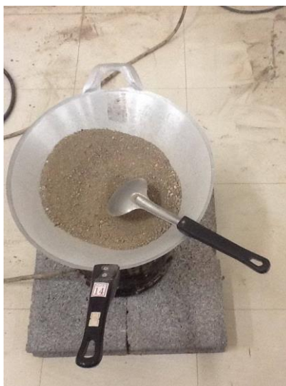
รูปที่ 3.4 นำดินตัวอย่างเตรียมไว้ใส่กระทะแล้วคั่วร้อน
