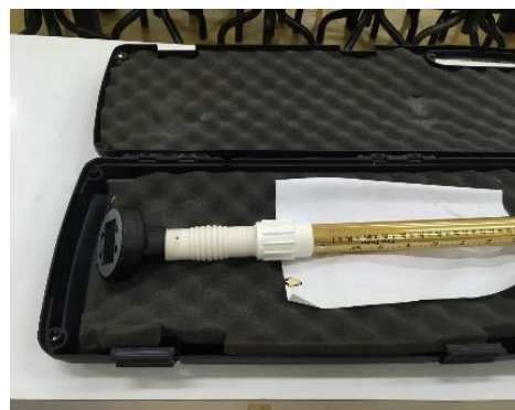
รูปที่ 2.12 เครื่องวัดอัตราการไหลของน้ำ FP101-102
