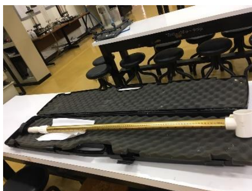
รูปที่ 3.2 เครื่องวัดอัตราการไหลของน้ำ FP101-102
