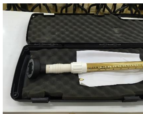
รูปที่ 3.2 เครื่องวัดอัตราการไหลของน้ำ FP101-102
