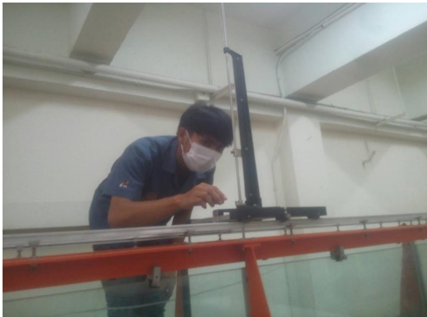
รูป ก-3 การวัดระดับน้ำและอ่านค่า
