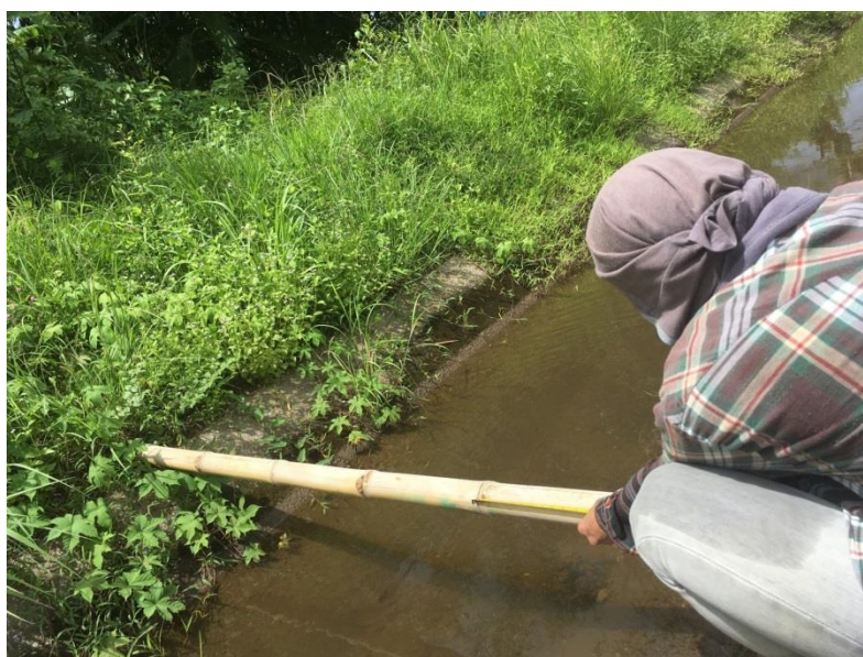
รูปที่ ค-4 การวัดระยะหน้าตัดการไหลของน้ำ
