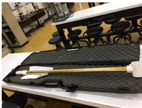
รูปที่ 2.12 เครื่องวัดอัตราการไหลของน้ำ FP101-102
