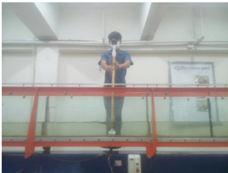
รูป ก-2 การวัดความเร็วของน้ำในรางด้วยเครื่องมือ
