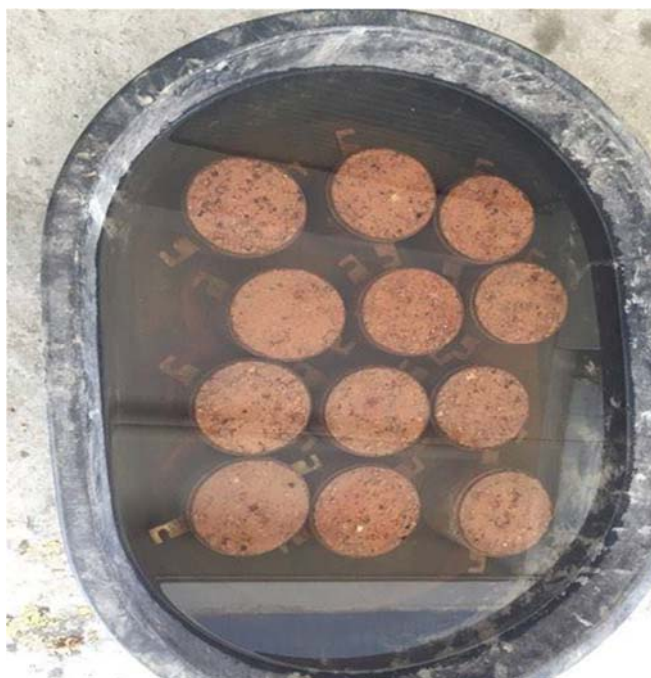
รูปที่ 3.5 ตัวอย่างดินซีเมนต์แช่น้ำก่อนทดสอบกำลังรับแรงอัดแบบไม่จำกัด
