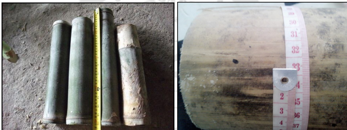
ภาพประกอบ 81 ขนาดไม้ไผ่สำหรับทำใบเสียง
