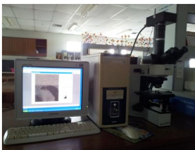
ภาพประกอบ 12 กล้องจุลทรรศน์ชนิดสะท้อนแสงต่อกับอุปกรณ์เสริมติดตั้งกล้องถ่ายภาพ
