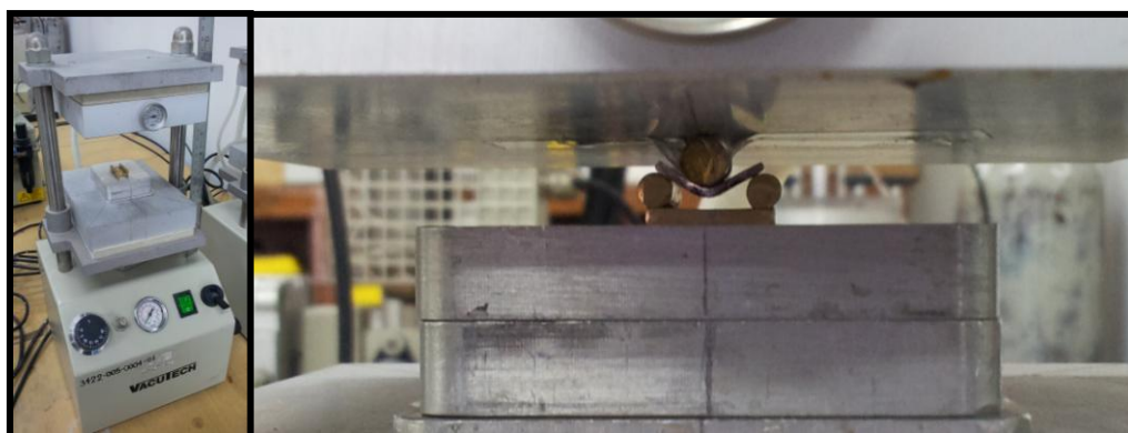
ภาพประกอบ 61 เครื่องมือสำหรับทดสอบการตัดโค้ง
