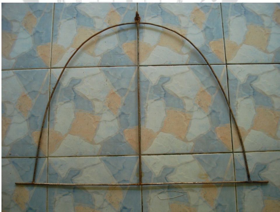
ภาพประกอบ 9 โครงเหล็กส่วนหางของหางหงส์ ชงตะขาบ
