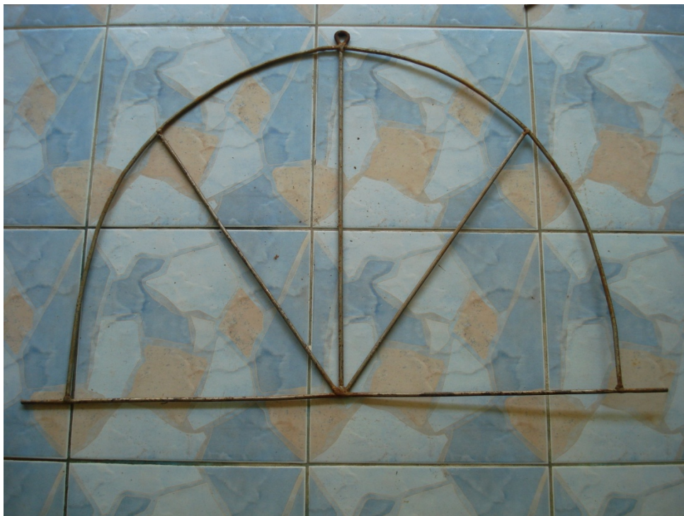
ภาพประกอบ 8 โครงเหล็กส่วนหัวของหางหงส์ ชงตะขาบ
