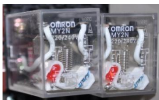
ภาพประกอบ 38 รีเลย์ ยี่ห้อ OMRON รุ่น MY2N, 220/240 VAC
