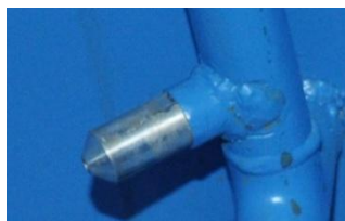
ภาพประกอบ 26 หัวฉีดน้ำสแตนเลส แบบ Axial Flow Full Cone
