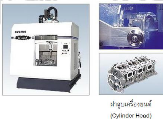
ภาพประกอบ 15 เครื่องล้างระบบน้ำแรงดันสูงแบบจมน้ำ
