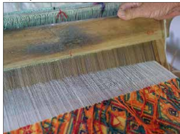
ภาพที่ 1 ฟืมไม้ที่ใช้ทอผ้าลาวครั้งในอำเภอบ้านไร่ จังหวัดอุทัยธานี ที่มา : นางสาวศศิชา ศรีจันทร์โถม (ผู้ช่วยวิจัย) เมื่อวันที่ 6 กุมภาพันธ์ 2565
