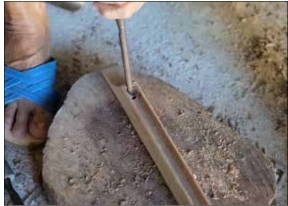
ภาพที่ 11 การเสาะร่องไม้ขอบล่าง ที่มา : ศศิชา ศรีจันทร์โถม เมื่อวันที่ 5 กุมภาพันธ์ 2565
