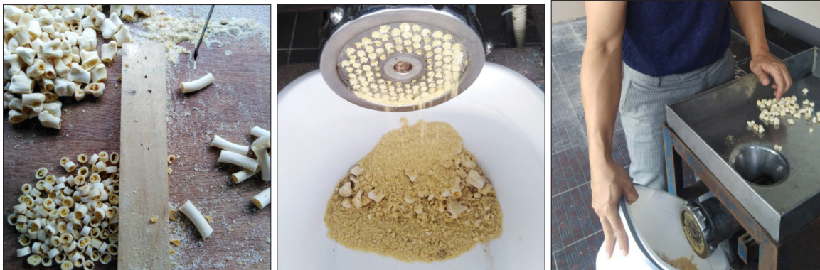
ภาพที่ 11 การตัดกระดุกไก่อเพื่อให้ได้สัดส่วนที่ต้องการและการบดเศษกระดุกไก่อที่แตกหักให้เป็นผง
