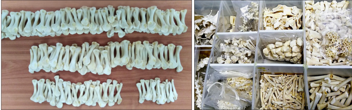
ภาพที่ 4 การคัดแยกขนาดและรูปทรงของกระดูกไก่ที่ผ่านการทำความสะอาดและฟอกสี
