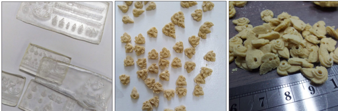
ภาพที่ 13 แม่พิมพ์เรซินที่ผู้วิจัยหล่อขึ้นเองและตัวอย่างผลงานที่ผ่านการอัดพิมพ์แล้ว
