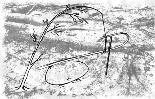
ภาพประกอบที่ 65: “แรวค่อม้า” (ดักสัตว์ใหญ่ขึ้นได้ กระจง เก้ง กวาง หมูใหญ่ หรืออื่น ๆ เป็นต้น)
