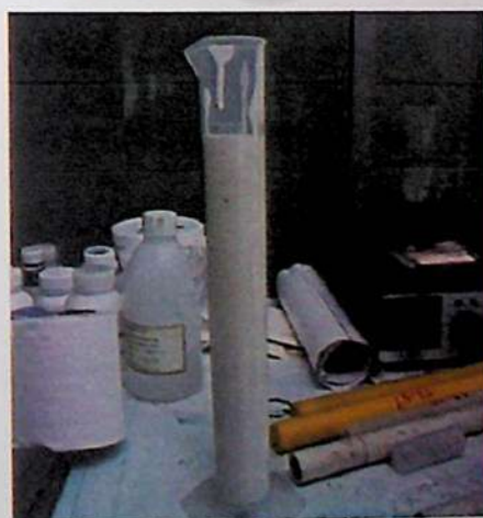
รูปที่ 4.18 ภาพถ่ายความถ่วงจำเพาะของสีอิมัลชันที่ทำการทดลอง
