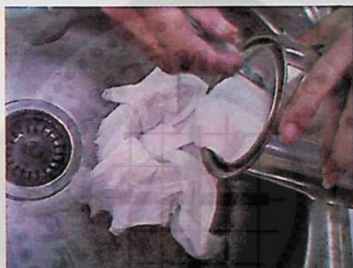
รูปที่ 3.2 นำสีที่ปั่นผสมแล้วมาเทใส่ผ้ากรองเพื่อแยกเนื้อสีออกจากลูกแก้วบดสี
