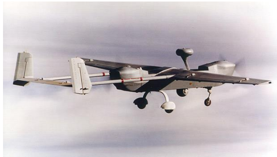
ภาพที่ 2 อากาศยานไร้คนขับรุ่น RQ-2A Pioneer
