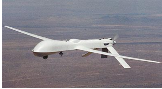
ภาพที่ 4 อากาศยานไร้คนขับรุ่น UAV RQ-1A Predator ที่มา : airforce-technology (2018)
