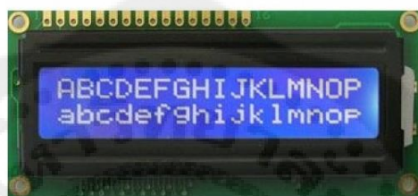
รูปที่ 2.20 แสดงลักษณะของโมดูล LCD
