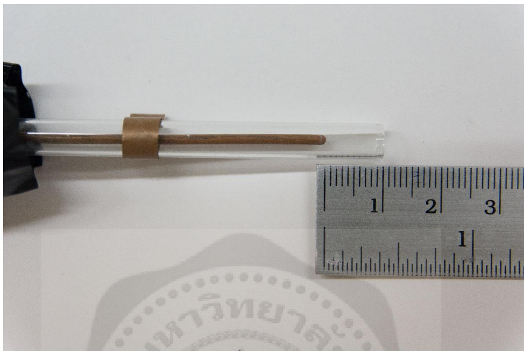
รูปที่ 4.21 อุปกรณ์และรูปแบบการสร้างอุปกรณ์การทดลองแบบการต่ออิลีกโทรดหรือแคโทดด้านนอก โดยใช้ขั้วแอโนดแบบลวดทองแดง.
