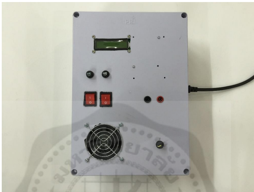
รูปที่ 1 ภาคผนวก ข ภายนอกกล่องเครื่องจ่ายไฟกระแสตรงแรงดันสูงที่สร้างขึ้น
