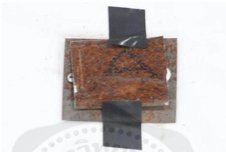
รูปที่ 4.25 ผลการการสปีดเตอร์ริงผิวแผ่นสังกะสีที่เกิดสนิมออก
