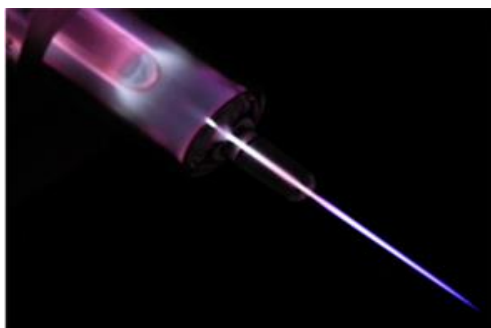
รูปที่ 1.1 ลำพลาสมาอุณหภูมิต่ำที่ความดันบรรยากาศ
