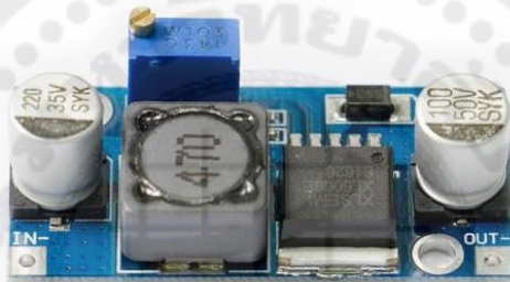
รูปที่ 3.2 XL6009E1 DC-DC Step Up Boost Converter
