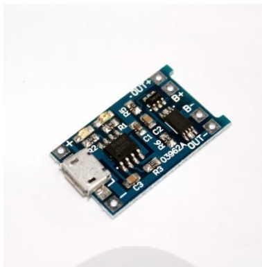
รูปที่ 3.12 TP4056 Lithium Battery Charger
