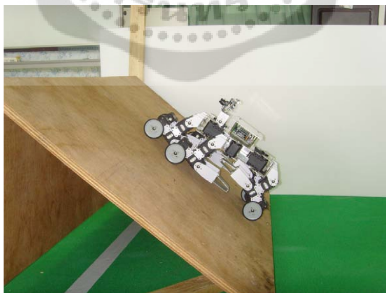
ภาพประกอบ 26 แสดงการทดสอบหุ่นยนต์เคลื่อนที่ขึ้นบนพื้นเอียงโดยใช้ล้อ
