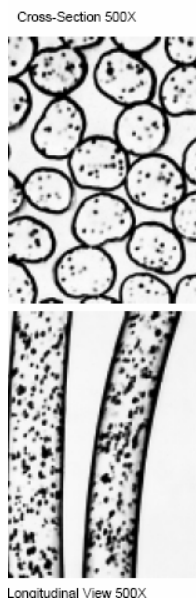
ภาพประกอบ 16 รูปภาพภาคตามขวางและตามยาวของเส้นใยอะคริลิก (AATCC Technical Manual Vol.83.2008: 48)
