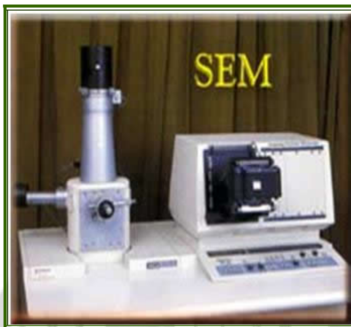
ภาพกล้องจุลทรรศน์อิเล็กตรอนแบบส่องกราด (Scanning Electron Microscope)
