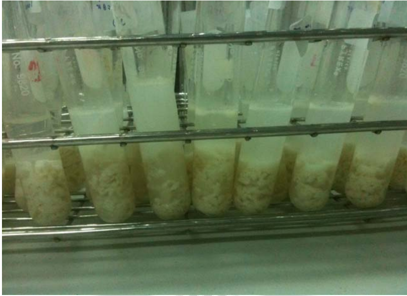
รูปภาคผนวกที่ 5 ตัวอย่างเนื้อใ้ที่ก้ำล้งสกัดสารมาลอนได้อลดีไฮด์ในตัวทำละลาย
