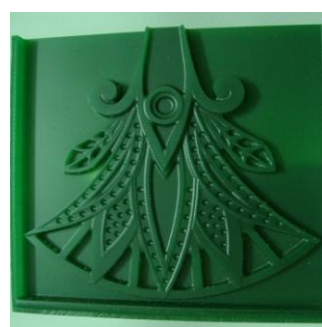
ภาพประกอบ 13 รูปภาพแสดงตัวอย่างต้นแบบซีผึ้ง (Wax) จากเครื่องซีเอ็นซี (CNC)
