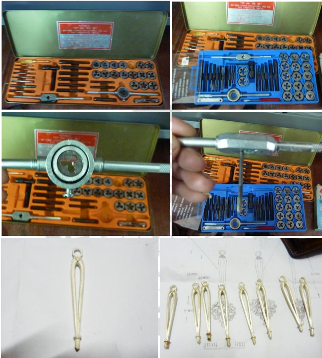
ภาพประกอบ 81 เครื่องมือกลึงเกลียวข้อต่อของจี้
