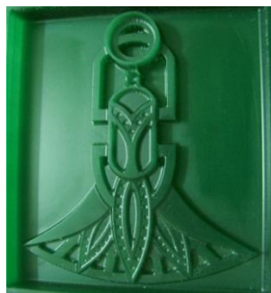
ภาพประกอบ 13 รูปภาพแสดงตัวอย่างต้นแบบซีผึ้ง (Wax) จากเครื่องซีเอ็นซี (CNC)
