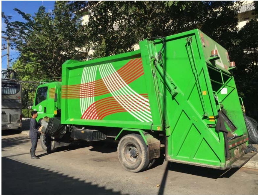
รูปที่ ค-7 รถเก็บขยะมูลฝอยแบบอัดท้ายความจุ 7 ลูกบาศก์เมตร
