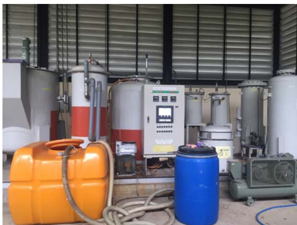
รูปที่ 4.8 เครื่องผลิตก๊าซไบโอมีเทนจากเศษอาหาร
