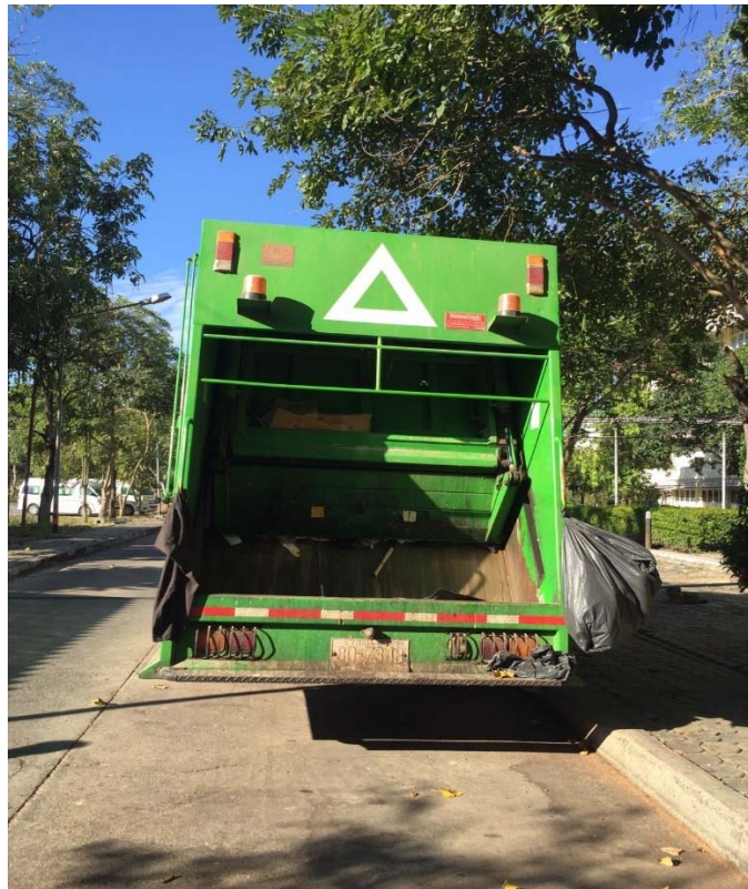
รูปที่ 4.2 (ต่อ) แสดงรถเก็บขนขยะแบบอัดท้ายความจุ 7 ลูกบาศก์เมตร
