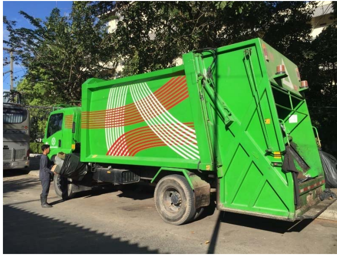
รูปที่ 4.2 แสดงรถเก็บขนขยะแบบอัดท้ายความจุ 7 ลูกบาศก์เมตร
