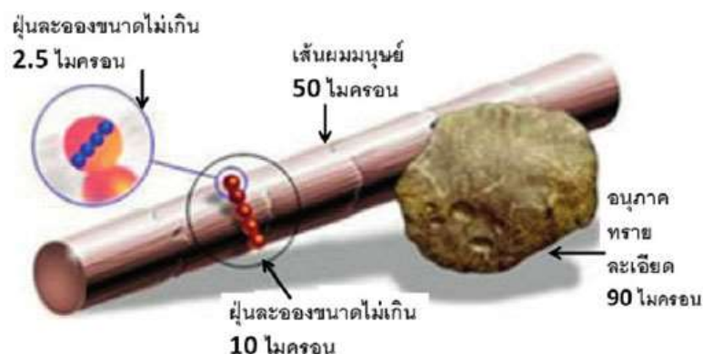
รูปที่ 2.1 แสดงการเปรียบเทียบขนาดของฝุ่นละอองขนาดเล็กที่มีผลกระทบต่อสุขภาพกับ อนุภาคทรายและเส้นผม
