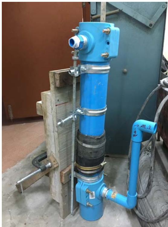
รูปที่ 3.6 เครื่องมือทดสอบการซึมผ่านของน้ำในคอนกรีต
