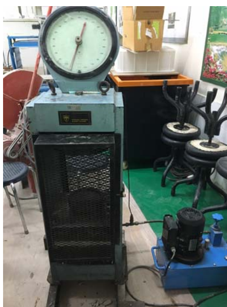
รูปที่ 4.1 เครื่องมือทดสอบกำลังรับแรงอัดคอนกรีต
