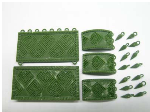
ภาพประกอบ ต้นแบบที่ผลิตโดยเครื่องฉีด Wax ระบบคอมพิวเตอร์และเครื่องฉีด Wax
