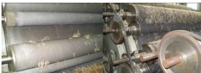
ภาพประกอบ 7 ลักษณะของเครื่อง ROLLER CARD ที่นวดเส้นใย
