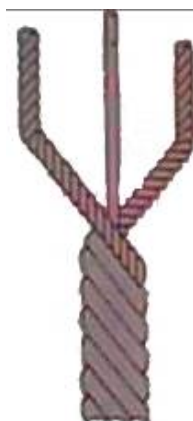
ภาพประกอบ 23 แสดงลักษณะของเส้นด้าย Core spun yarn
