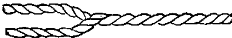
ภาพประกอบ 20 แสดงลักษณะของเส้นด้ายรวม (Ply yarn)
