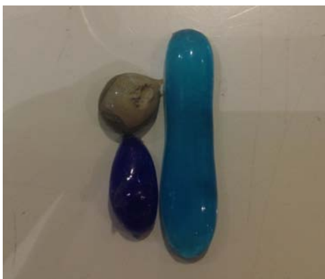
ภาพประกอบ กระจกสีอบที่อุณหภูมิ 700 องศาเซลเซียส เวลา 30 นาที
