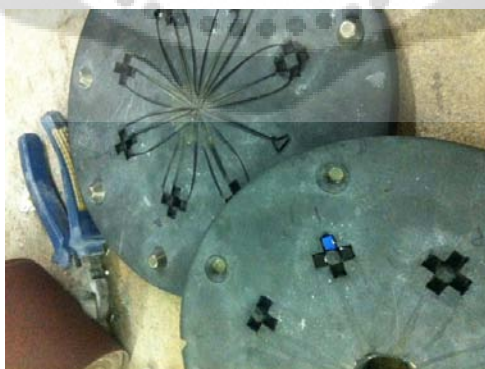
ภาพประกอบ 45 พิมพ์ยางสำหรับการหล่อแบบเหวี่ยง (Centrifugal Casting)
