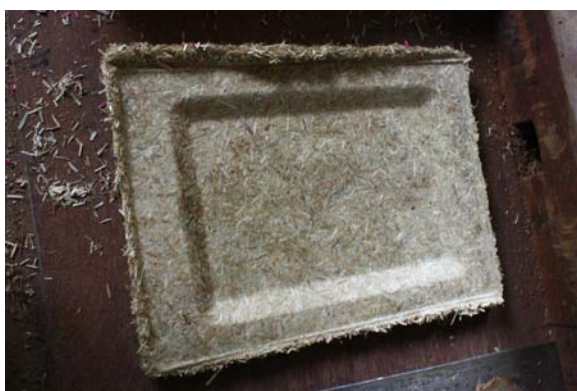
ภาพประกอบ 52 แสดงแผ่นแปรรูปจากวัสดุต้นรูปถาษีโดยวิธีการอัดขึ้นรูป
