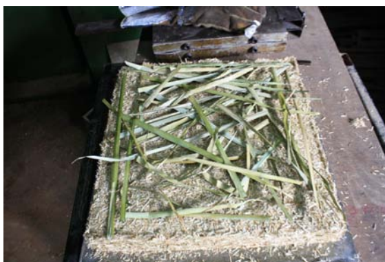
ภาพประกอบ 44 แสดงการทำลวดลายให้กับแผ่นแปรรูปจากวัสดุต้นรูปถั่วเขียว
