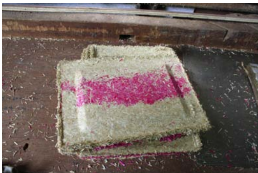
ภาพประกอบ 55 แสดงแผ่นแปรรูปจากวัสดุต้นฐูปถาษีที่ข้อมสีและสร้างลวดลาย
