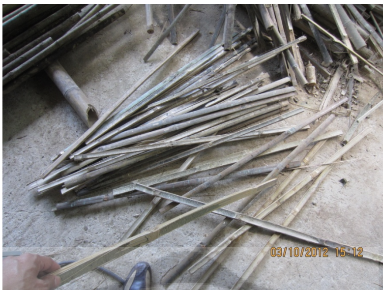
ภาพประกอบ 70 เส้นไม้ไผ่ที่ผ่านการเข้าเครื่องจักรตอก
