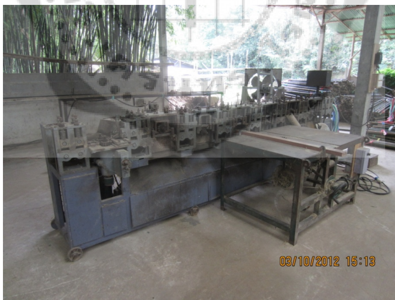
ภาพประกอบ 71 เครื่องขัดเส้นไผ่ (ขัดแบบหยาบ)
