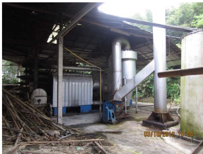
ภาพประกอบ 66 เครื่องจักรสำหรับอบลำไ้ เป็นอุปกรณ์ที่ทำไอน้ำส่งผ่านท่อส่งมายังตู้อบลำไ้
