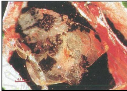
ภาพประกอบ 8 แสดงตำหนิรอยแตกร้าวภายในของสปีเนล (Bunnag. 2004)
