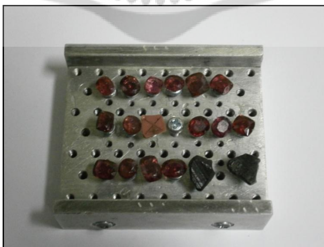
ภาพประกอบ 19 แสดง sample holder พร้อมนำไปใส่ใน Analysis Chamber
