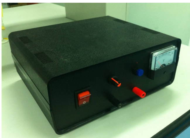
ภาพประกอบ 11 แหล่งกำเนิดไฟฟ้ากระแสตรงแบบกำลังต่ำที่สร้างขึ้น
