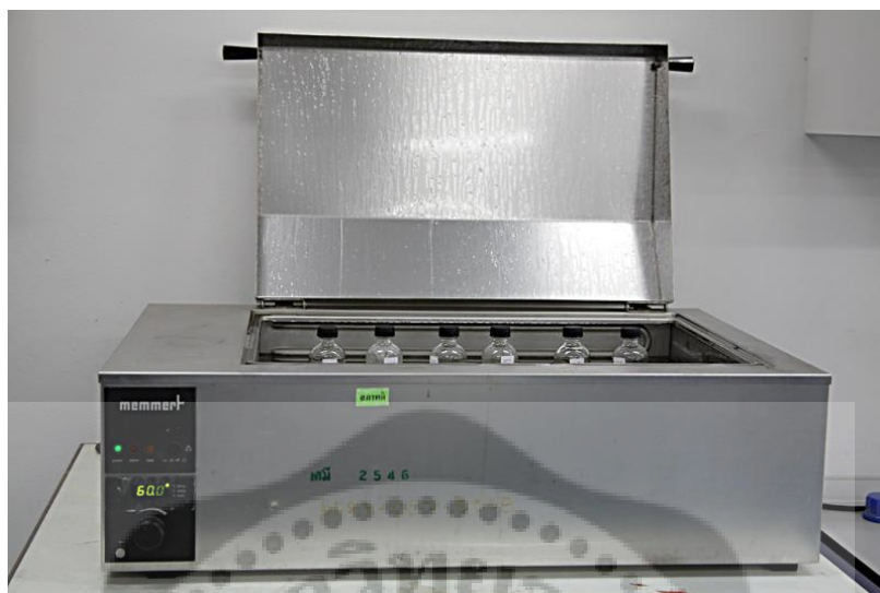
ภาพประกอบ 28 เครื่องอังไอน้ำที่สามารถควบคุมอุณหภูมิได้ใช้ในการให้ความร้อนในการเตรียมอนุพันธ์
