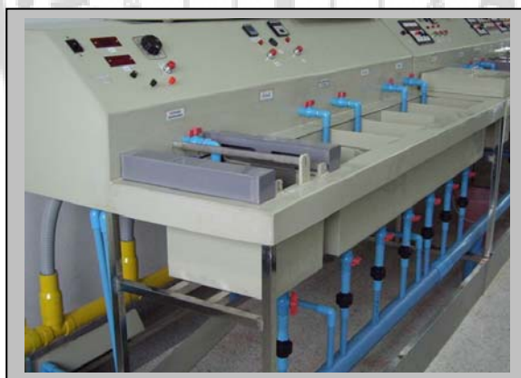
ภาพประกอบ 36 แสดงถึง PP ขนาด 15 ลิตร แบบ Plating Jig
