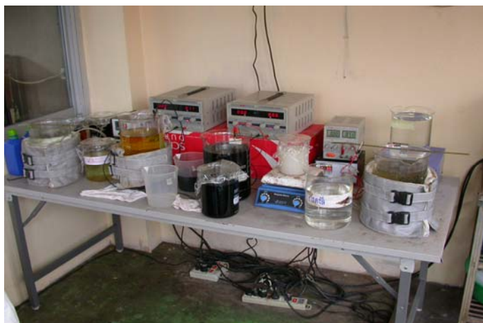
ภาพประกอบ 20 แสดงถังชุบแบบบีกเกอร์อย่างง่าย ขนาด 3 ลิตร และ 5 ลิตร
