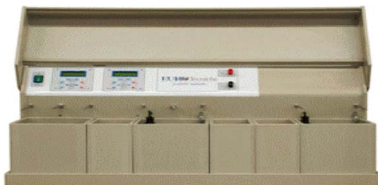
ภาพประกอบ 23 แสดงถังชุป Polypropylene ขนาด 8 ลิตร
