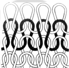
ภาพประกอบ 24 การถักนิตแบบริบหรือลูกฟูก
