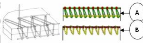
การคล้องห่วงของเส้นด้าย A คือ ด้านบน และ B คือ ด้านล่าง
