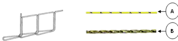
การคล้องห้วงของเส้นด้าย A คือ ด้านบน และ B คือ ด้านล่าง
