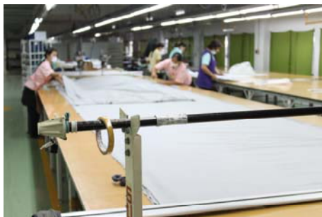
ภาพประกอบ 37 โตะปูผ้าชนิดใช้มือปูบนพื้นราบ
