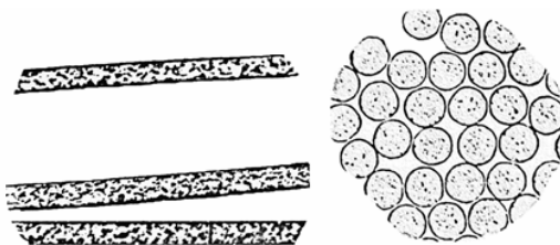
ภาพประกอบ 12 รูปร่างตามยาวและตามขวางของไนลอน
