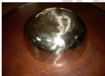
ภาพประกอบ 32 ภาพภาชนะ ในลักษณะต่างๆ ที่ผ่าน กระบวนการเจียร และ กระบวนการขัดเรียบร้อยแล้ว
