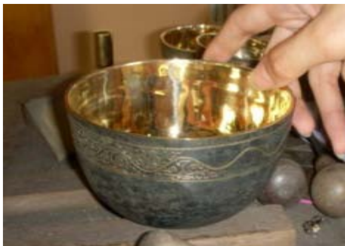
ภาพประกอบ 47 ภาพตัวอย่าง ผลิตภัณฑ์ทองลงหินที่กำลัง อยู่ในขั้นตอนการแกะลวดลาย
